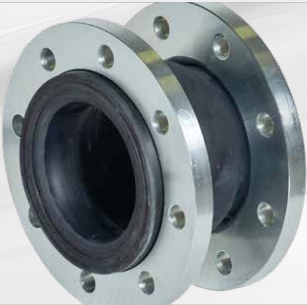
Giunto antivibrante flangiato Corpo in EPDM Flange in acciaio al carbonio zincate Rubber expansion joint flanged end
