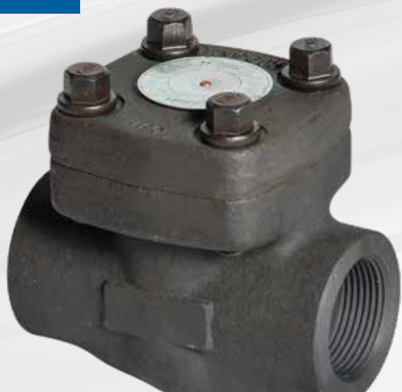
Valvola di ritegno a battente classe 800 lbs A105N / trim 8 - Passaggio ridotto Forged swing check valve class 800 lbs - Reduced bore
