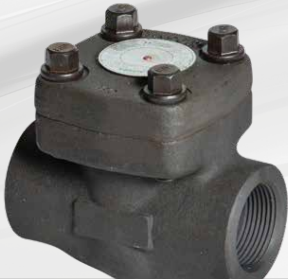
Valvola di ritegno a pistone classe 800 lbs A105N / trim 8 - Passaggio ridotto Forged piston check valve class 800 lbs - Reduced bore
